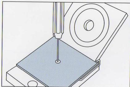
中心のネジをプラスのドライバーで外し、カuttingベースを付け替えてください。
