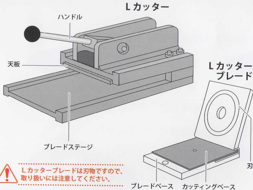
原稿の切れが悪くなった場合は、ブレードのカuttingベースを付け替えてください。
